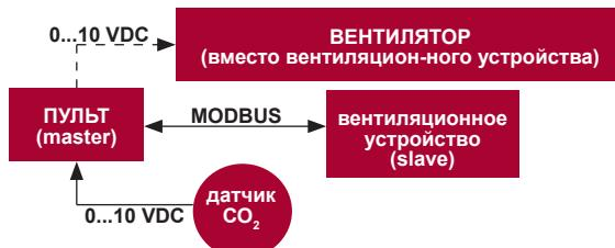
Используя этот пульт и преобразователь CO<sub>2</sub>, можно уменьшить уровень углекислого газа в помещении. Просто к самому пульту нужно подключить датчик CO<sub>2</sub> 0..10 VDC и сконфигурировать пульт. В служебном режиме в пункте F.14 необходимо выставить 2, а F.15 и F.16 настроить в соответствии со спецификацией датчика.
