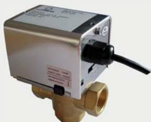
Зональные клапаны ZV-S рекомендуется для всех систем отопления и охлаждения, где требуется функция безопасности в случае отключения электроэнергии. В этом случае возвратная пружина обеспечивает закрытие клапана
