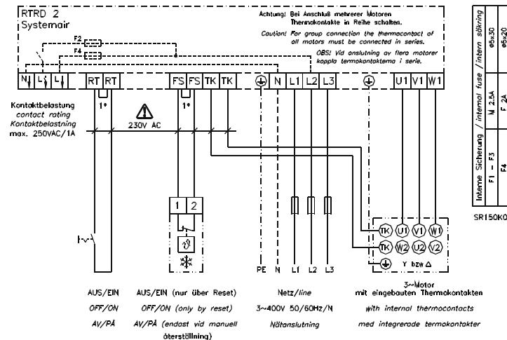
1\* = Bei Fernsteuerung (EIN/AUS) über die Klemmen RT-RT bzw. FS-FS Brücken entfernen.
