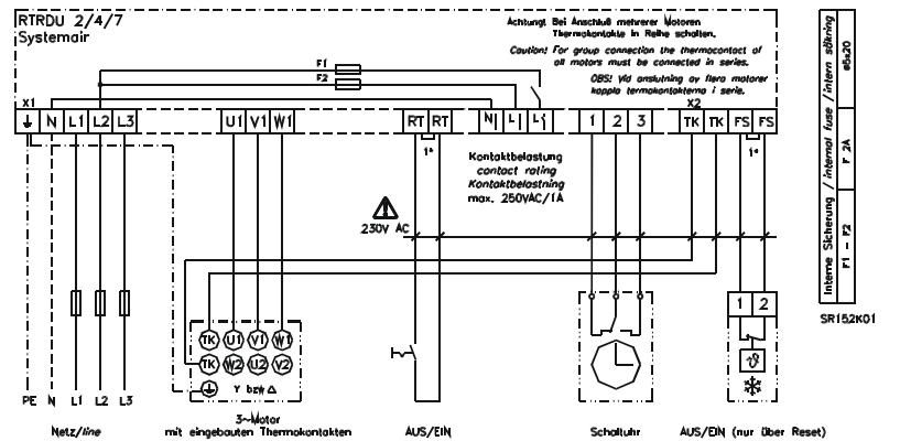
1\* = Bei Fernsteuerung (EIN/AUS) über die Klemmen RT-RT bzw. FS-FS Brücken entfernen.
