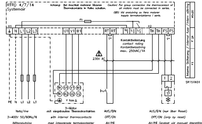
1\* = Bei Fernsteuerung (EIN/AUS) über die Klemmen RT-RT bzw. FS-FS Brücken entfernen.
