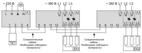
А1 – блок управления терморегулятора МРТ380.14;
