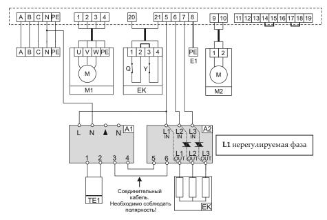
M1- приточный вентилятор мощностью до 7,5 кВт, 400 В;
