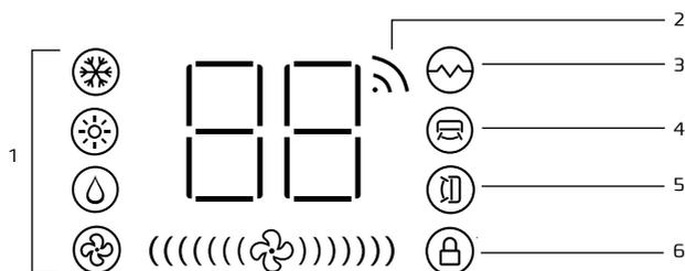
1. Индикация режимов работы: охлаждение/обогрев/осушение/вентиляция
