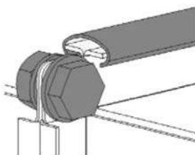
К воздуховодам вентилятор монтируется болтами и С-профилем.
