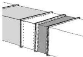
Для монтажа вентилятора рекомендуется использовать гибкие соединительные вставки, которые существенно сокращают передачу шума в воздуховод. Вентилятор может устанавливаться в любом положении. При подключении воздуховодов обратите внимание на направление воздушного потока, указанное на корпусе изделия.
