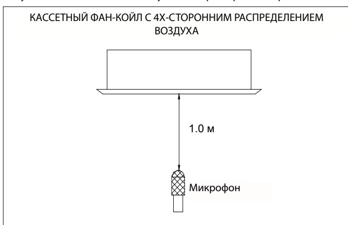
Рисунок №6 Схема испытаний шумовых характеристик агрегатов
