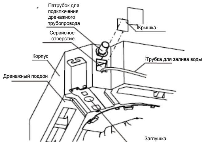
Рисунок №13 Монтаж дренажного трубопровода
