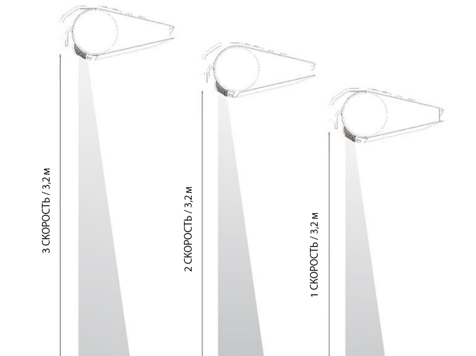
РИС. 2.2 ДЛИНА ПОТОКА ВОЗДУХА НА КАЖДОЙ СКОРОСТИ.
