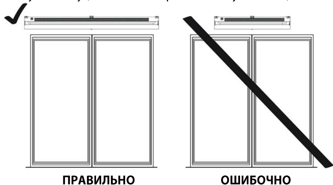
РИС. 7.1 ПРАВИЛЬНАЯ ГОРИЗОНТАЛЬНАЯ УСТАНОВКА.
